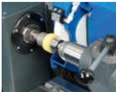
Halbautomatisches Schleifen von Luftspinn- und OE-Walzen.
