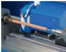
Halbautomatisches Schleifen von Vorbereitungsbezügen mit Durchmessern von 19 bis 140 mm und einer maximalen Länge von 500 mm.
