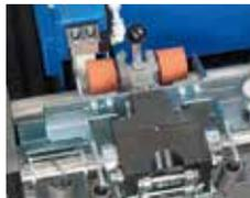
Optionales halbautomatisches Schleifen von Bezügen mit Hilfsschleifvorrichtung (Oberwalzen, Ringspinnmaschinen, Flyer).
