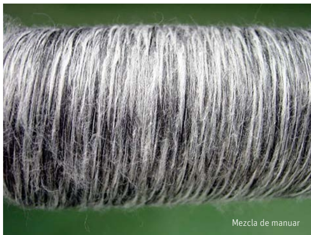
Fig. 1: La mezcla de copos proporciona una mecha más homogénea.
