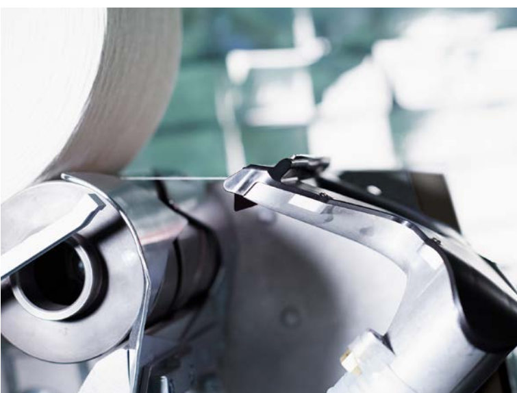
Fig. 1: El tubo del brazo de aspiración optimizado permite una recogida segura del hilo cuando se busca el hilo superior.
