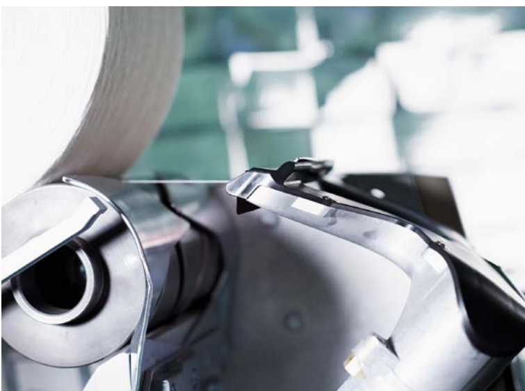
Abb. 1: Bei der Oberfadensuche ermöglicht das optimierte Saugarmrohr eine zuverlässige Fadenerfassung.
