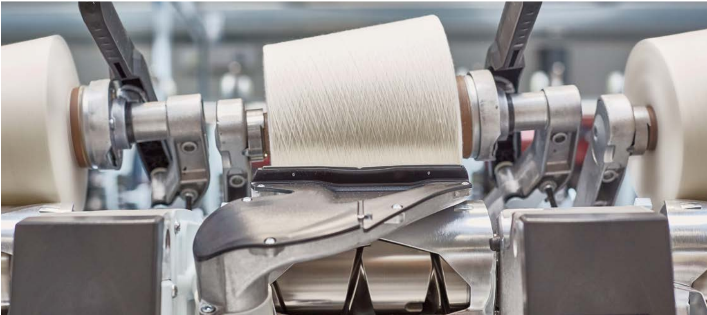
Abb. 5: Effizienz in Oberfadensuche und Garnreinigung dank intelligenter Schaltungsabläufe
