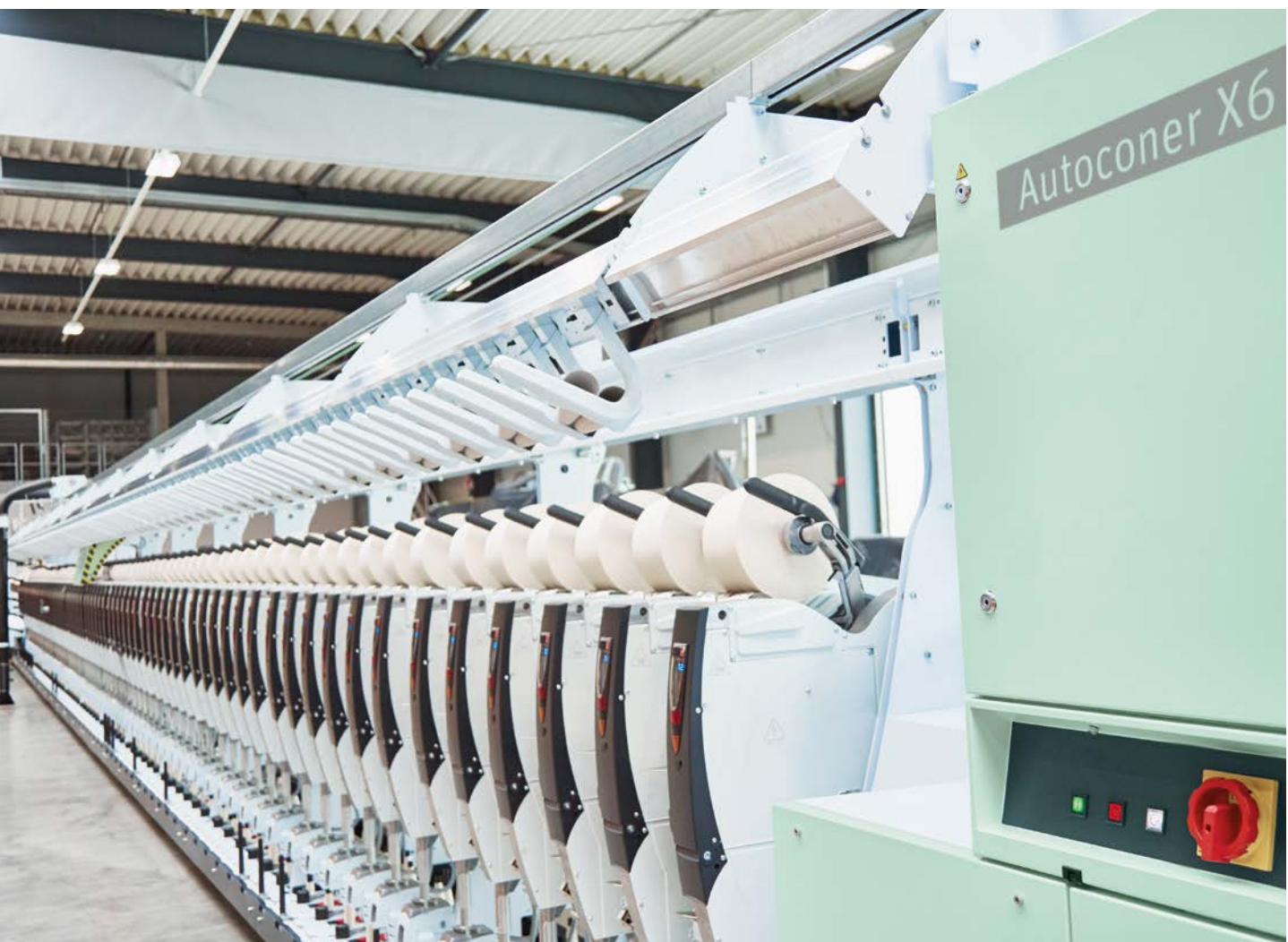
Abb. 1: Der Autoconer X6 ist die finale Qualitätssicherung im Ring- und Kompaktspinnprozess.
