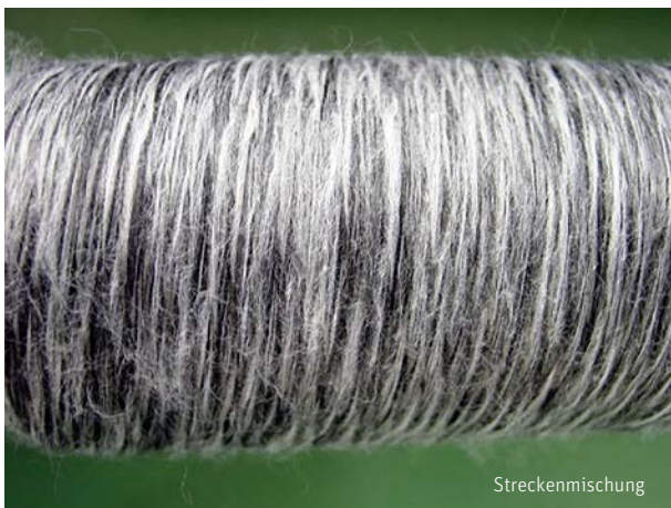
Abb. 1: Die Flockenmischung liefert ein homogeneres Vorgarn.
