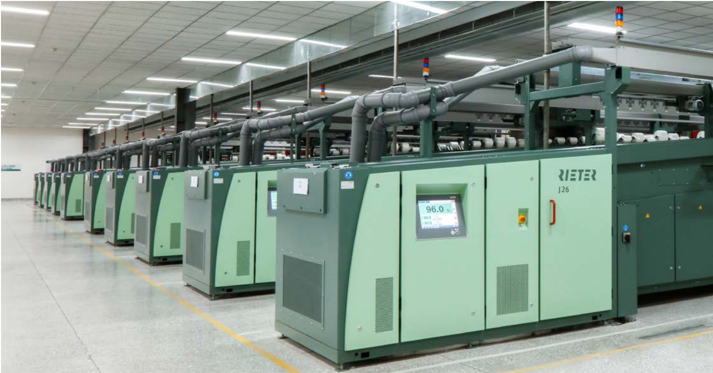
J 26 hava jetli iplik makinalarının kullanıldığı bir Rieter iplikhanesi, son derece ekonomik olarak benzersiz pamuk iplikleri üretir.
