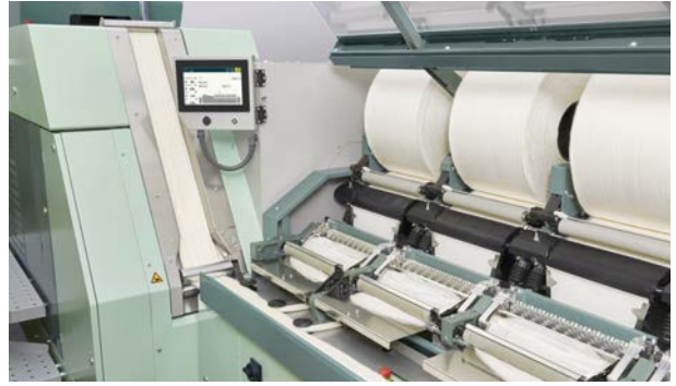
Yeni penye makinası E 90, entegre SB-D 50 cer teknolojisi sayesinde en yüksek şerit kalitesini üretir.
