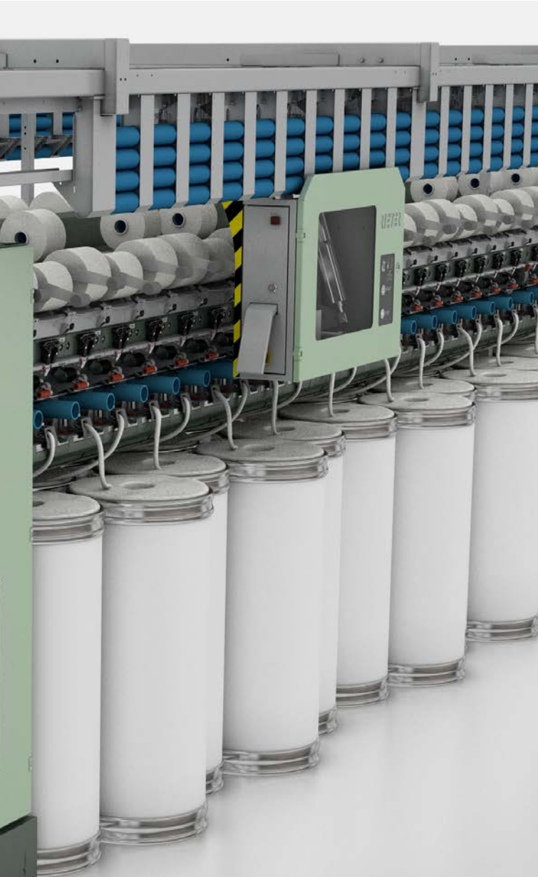
R 37: Geniş uygulama aralığı, yüksek verimlilik ve düşük enerji tüketimi. Bobin değişimi otomatik olarak gerçekleşir.
