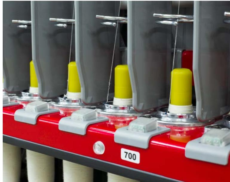
**Fig. 2:** La versión premium del sistema de monitoreo de husos individuales (ISM) está integrada en los modelos G 38 y K 48. Esto reduce los requisitos de personal.
