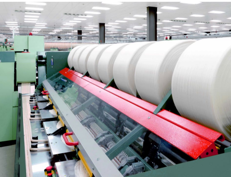
Il. 5 La E 86 con mayor grado de limpieza: menos impurezas sin dañar la fibra.
