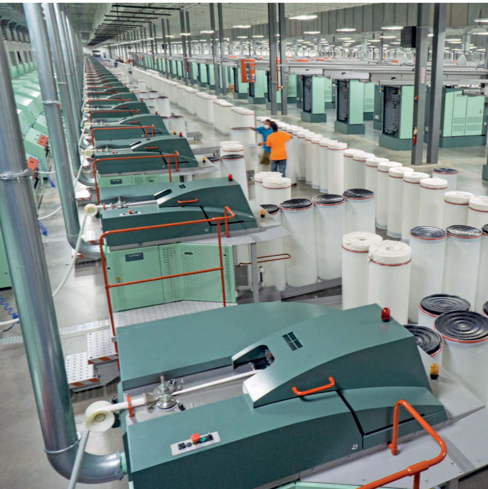
II. 2 Carda C 70 con módulo RSB - acortamiento del proceso y preparación óptima de la cinta para las máquinas de hilar a rotores.
