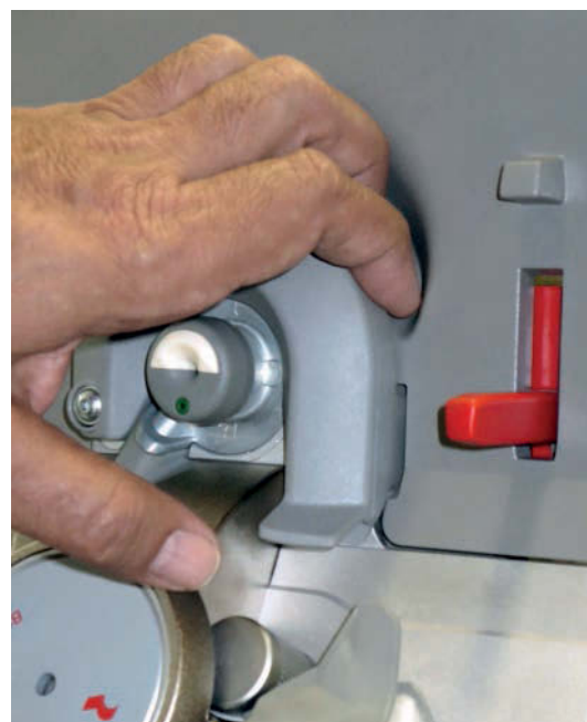
II. 3 La nueva caja de hilatura S 66 se puede abrir fácilmente y ahorra tiempo del operario.
