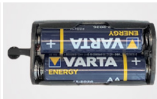
Soporte de batería modificado
