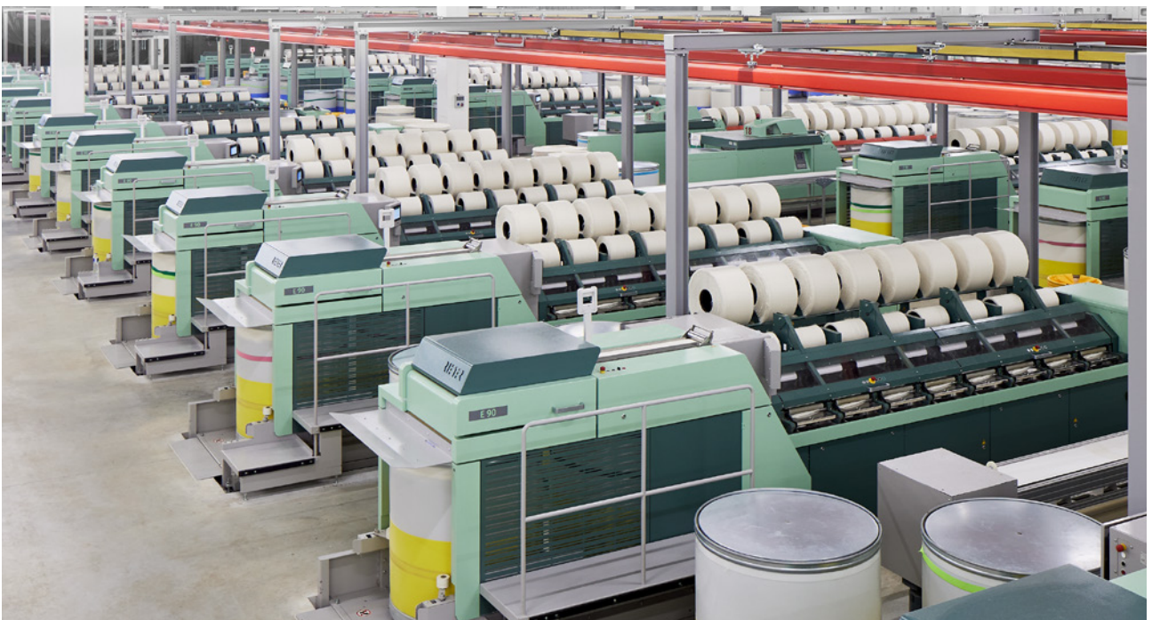
新机器在布局上允许机器布置间距缩小11%
