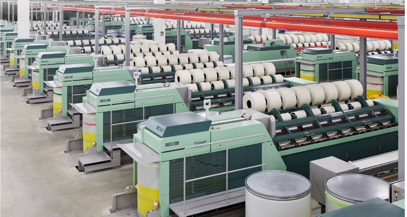
Yeni makina yerleşimi %11 oranında daha yakın makina yerleşimine olanak verir
