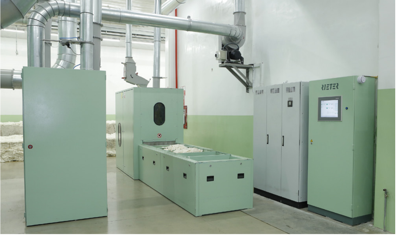
Harman hallaç ve taraktan geriye doğru ölçülü telef besleme
