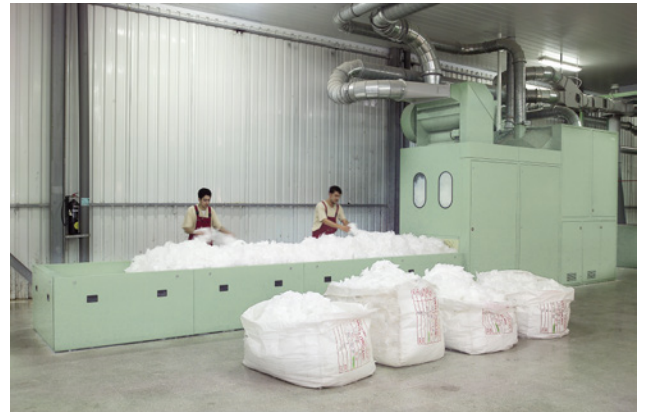
Karıştırıcı balya açıcı B 34: küçük partilerin esnek karışımı
