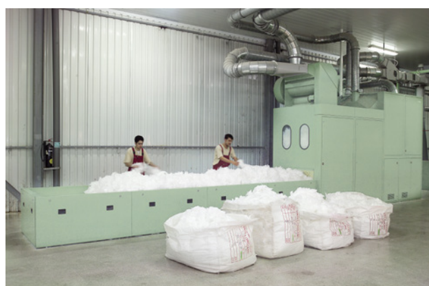
Mischballenöffner B 34: flexibles Mischen von kleinen Partien
