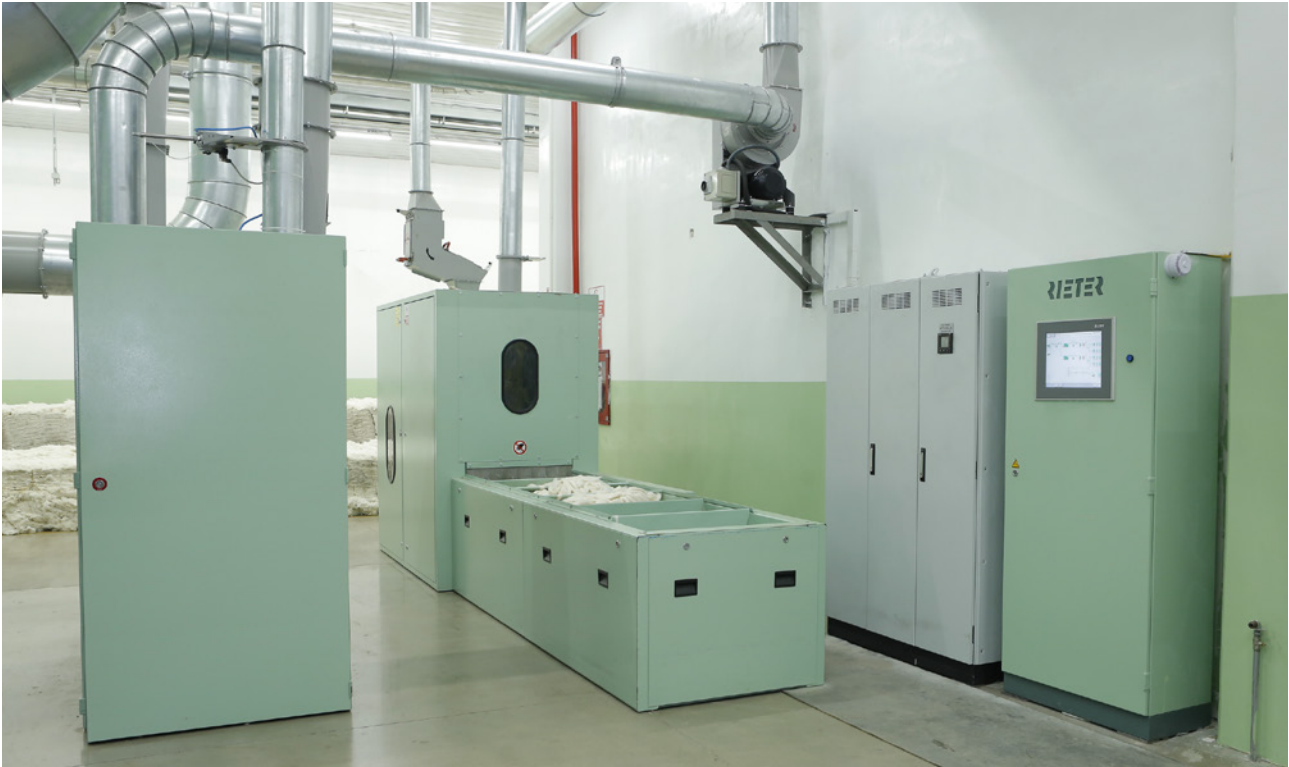
Dosierte Rückspeisung von Putzerei- und Kardenabgängen
