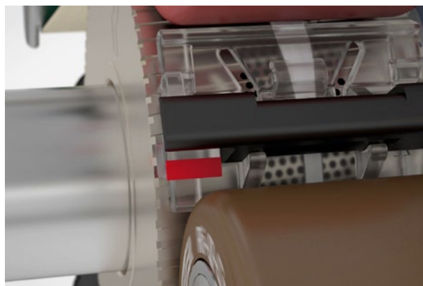
气流导向控制元件上的红色标记表示必须检查集聚单元。
