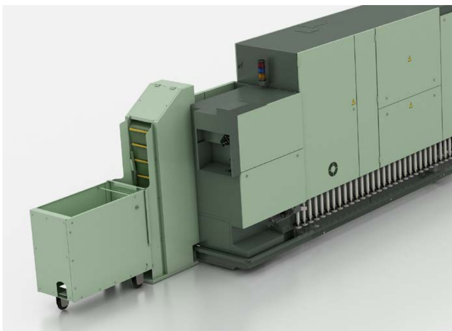
WILDload系统：纱管被一个接一个地拣出，经过对齐后喂入纱管装载装置ROBOload中。
