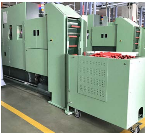
配有WILDload辅助系统的全自动纱管装载系统ROBOload
