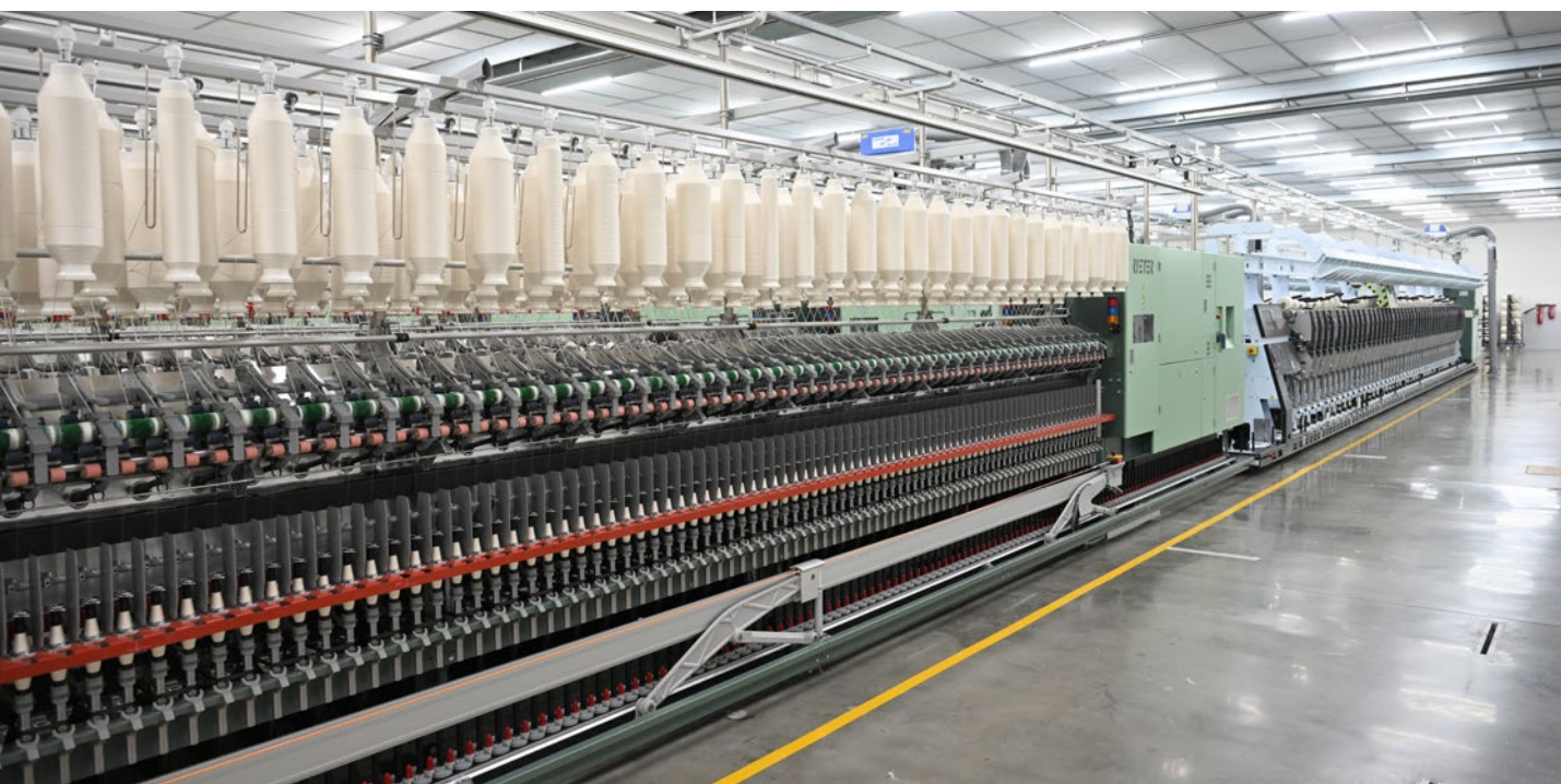
使用多联式细络联Multilink系统连接到络筒机
