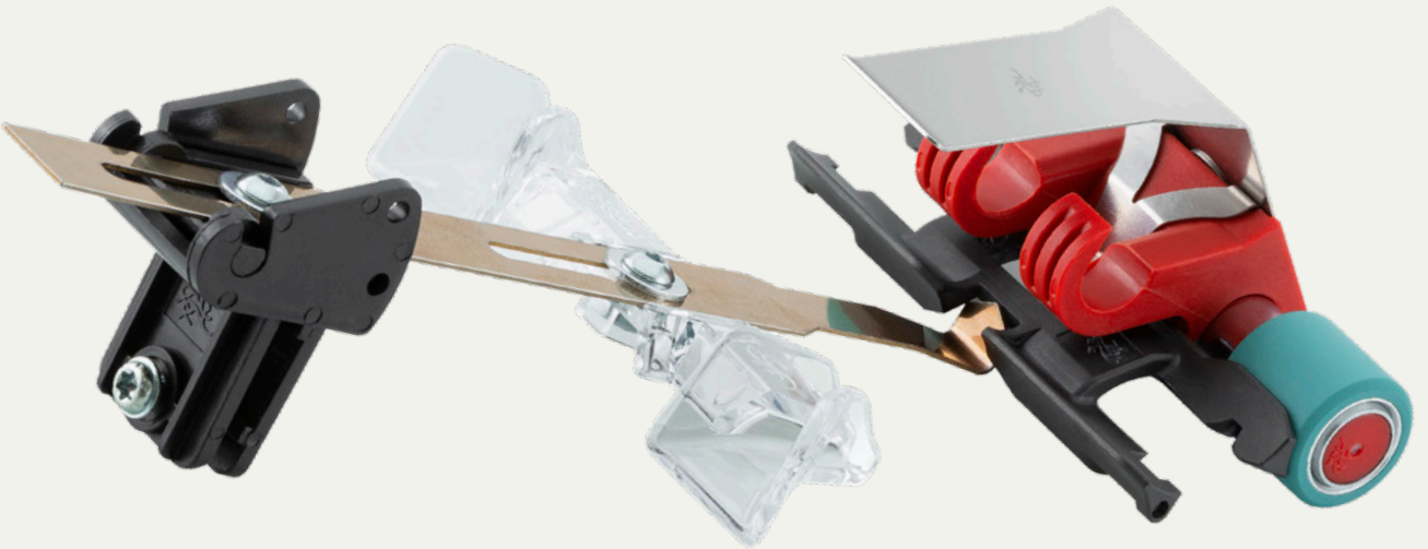
Travers hareketin Kompaktöre aktarılması (arka taraftan görünüş)
