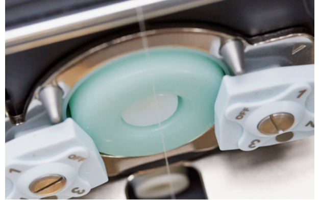
Herhangi bir iplik tipinin mükemmel ve hassas bir şekilde parafinlenmesi için parafinleme tertibatı
